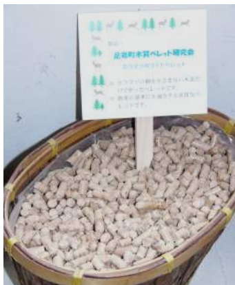
カラマツのホワイトペレット (足寄町木質ペレット研究会製造)
