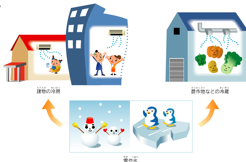
図 4-7-1 雪氷熱エネルギー利用のイメージ図 【出典】新エネルギー財団
