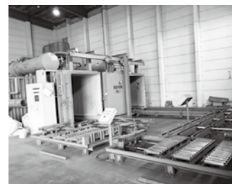
▲朝もぎトウモロコシの品質を保つために欠かせない真空予冷機
